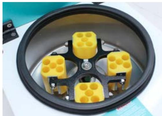
ROTOR EM LIGA DE AÇO ESPECIAL, COM SISTEMA HORIZONTAL PARA 4 PORTA-TUBOS.
