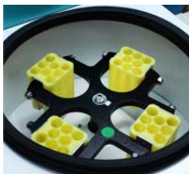
ROTOR EM LIGA DE AÇO ESPECIAL, COM SISTEMA HORIZONTAL PARA 4 PORTA-TUBOS.
